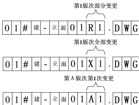
图 12.3.2-2 工程图纸文件变更表示方式
