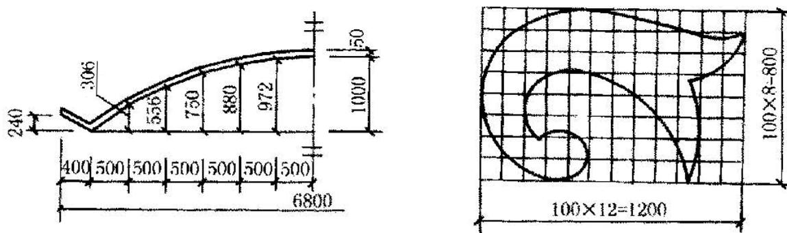
图 11.6.4 坐标法标注曲线尺寸 图 11.6.5 网格法标注曲线尺寸
