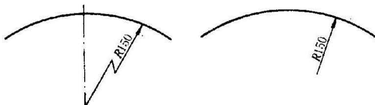
图 11.4.3 大圆弧半径的标注方法
