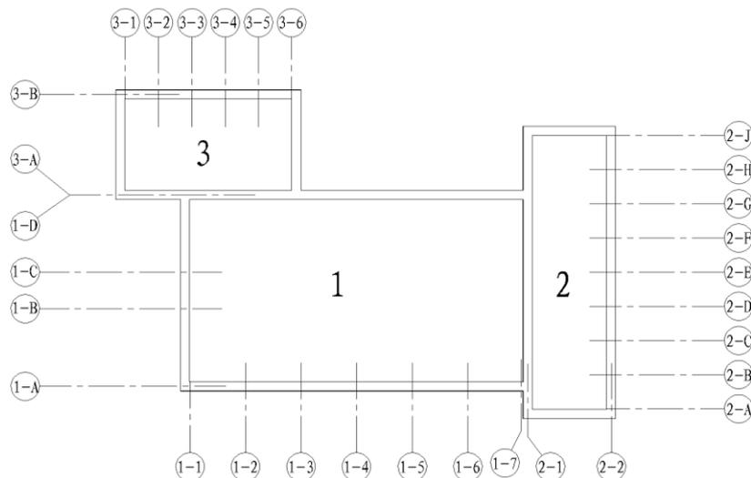
图 7.0.5 定位轴线的分区编号
