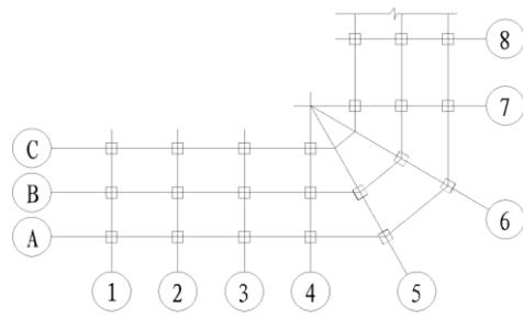
图 8.0.10 折线形平面定位轴线的编号
