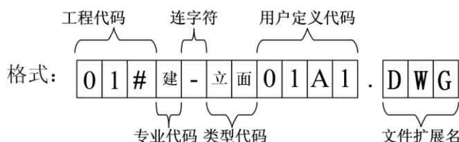
图 12.3.2-1 工程图纸文件命名格式
