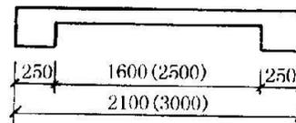
图 11.7.5 相似构件尺寸标注方法
