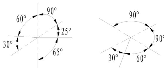
图 10.5.6 轴测图角度的标注方法
